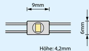
Anschlussschema LED-Modulkette Minimodul 2835 (mittige 5V / 12V-Einspeisung)
