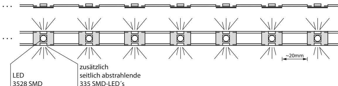
Diese anwenderfreundlichen und lichtstarken Einlegestripes sind speziell zum Vergießen in ausgefräste Nuten von Acryl-Buchstaben entwickelt. Durch die flache Bauart von nur 2,8mm sind sie besonders für flache und filigrane Projekte geeignet.
