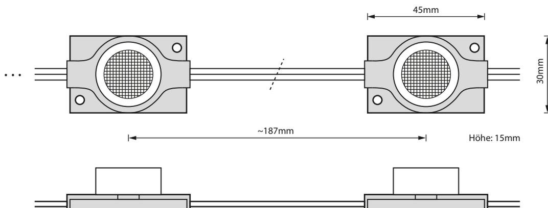
Diese 2W High Power Zargenmodul-Kette ist flexibel, selbstklebend und nach jedem Modul trennbar. Die spezielle Linsenoptik aus PMMA erlaubt eine helle und homogene Ausleuchtung von Leuchtkästen über die Zarge bzw. Kante mit einer Tiefe von ca. 10-20cm.
