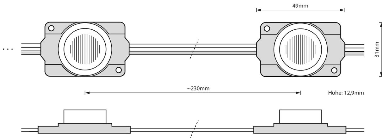
Diese 3W High Power Zargenmodul-Kette ist flexibel, selbstklebend und nach jedem 3. Modul trennbar. Die spezielle Linsenoptik aus PMMA erlaubt eine helle und homogene Ausleuchtung von Leuchtkästen über die Zarge bzw. Kante mit einer Tiefe von ca. 10-20cm.
