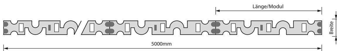
Anschlussschema flexLED-Platinenketten: Die gesamte Länge darf 5000mm nicht überschreiten. Wenn 5000mm überschritten werden, muss eine neue Zuleitung vom Konverter installiert oder ein neuer Konverter gesetzt werden.
